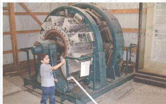
شکل ۱-۲ مبدل گردان موجود در موزه‌ی راه‌آهن ایلینویز با توانایی تبدیل ولتاژ  $ac$  به  $600$  ولت
