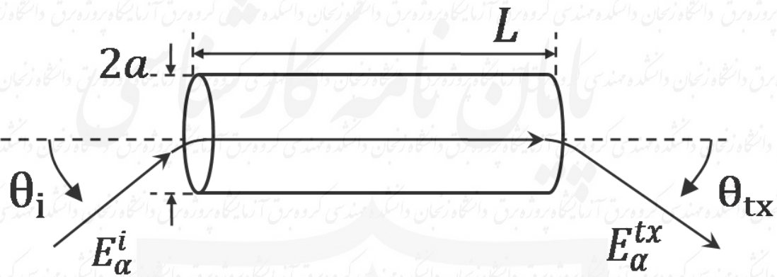
شکل ۲،۲، موجبر استوانه ای با دو طرف باز
