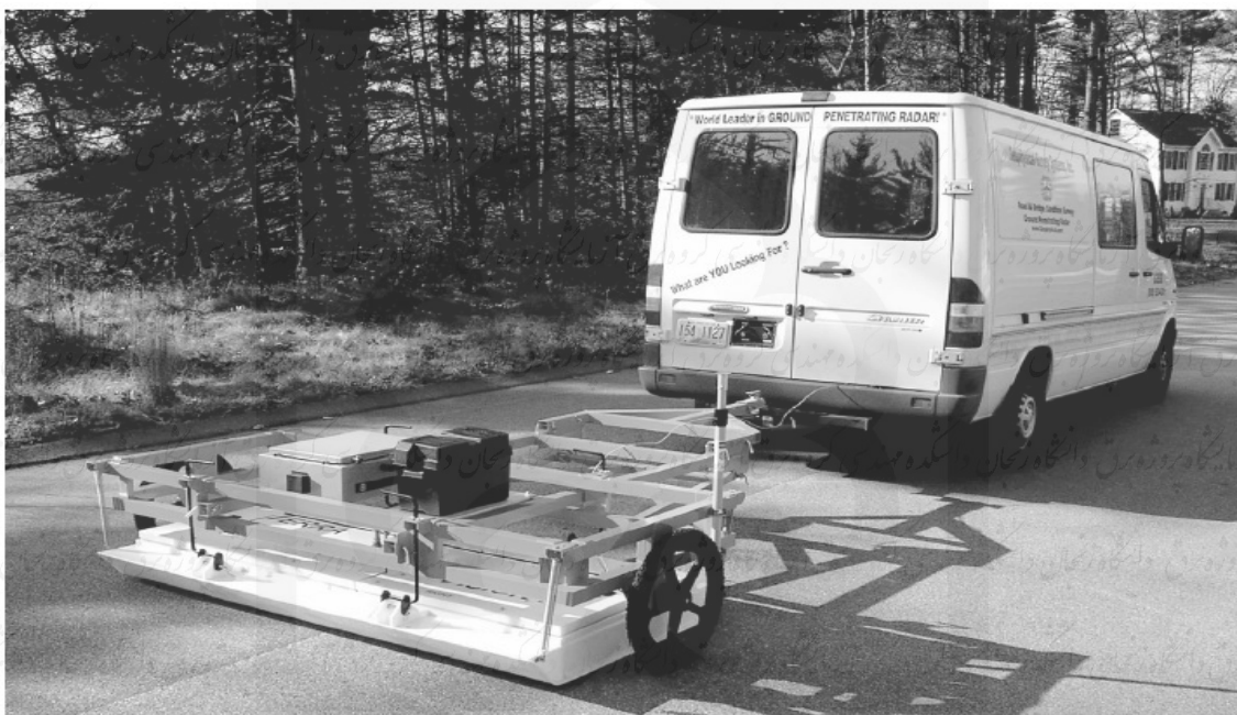
۴-۱- آزمایش رادارهای نفوذی زمین در تعیین ضخامت جاده
