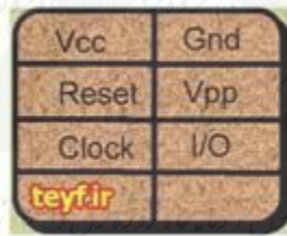
شکل (5) قسمت های مختلف کنتاکت های کارت هوشمند تماسی
