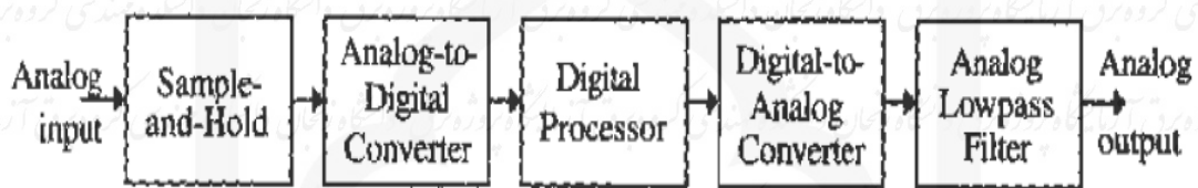
شکل ۲-۵ بلوک پردازش دیجیتالی یک سیگنال آنالوگ (بر گرفته از [۱])
