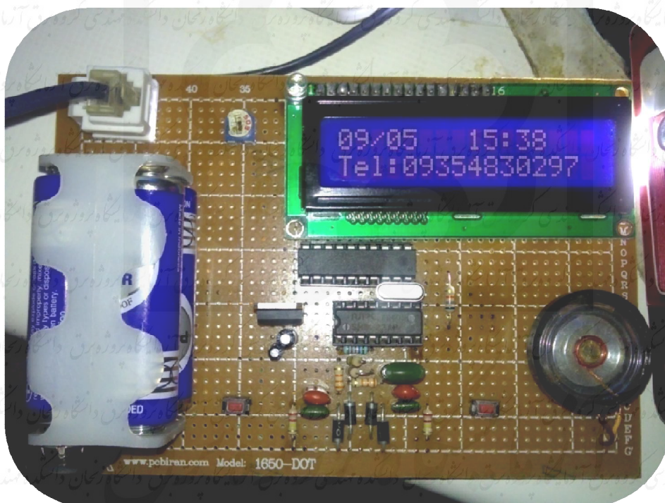
شکل (۸): پروژه ساخته شده روی فیبر سوراخ دار
