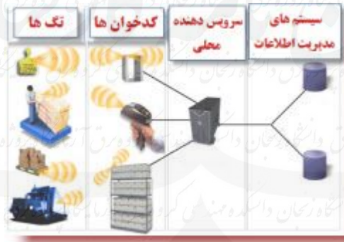
شکل 3 : نحوه کار RFID
